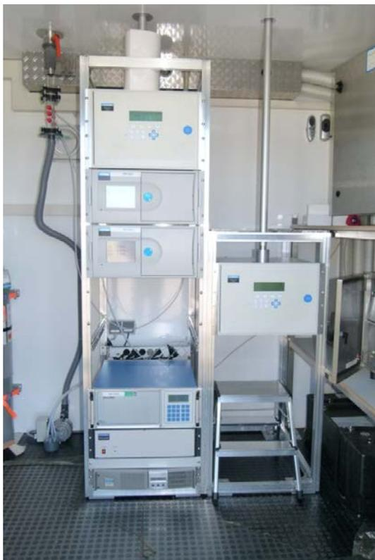
Abbildung 5. Innenausstattung der mobilen Luftgütemessstation.
