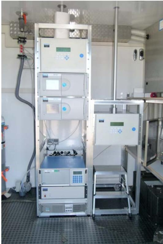
Abbildung 13. Innenausstattung der mobilen Luftgütemessstation.
